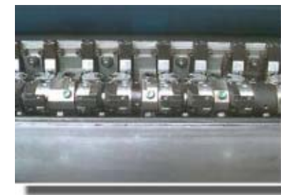
Maschine nach dem Trockeneisstrahlen
