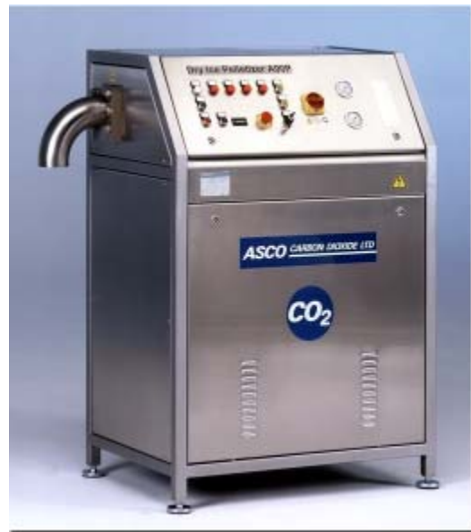
Pelletizer Typ A90P als alleinstehende Einheit für die Herstellung von hochverdichteten Pellets
