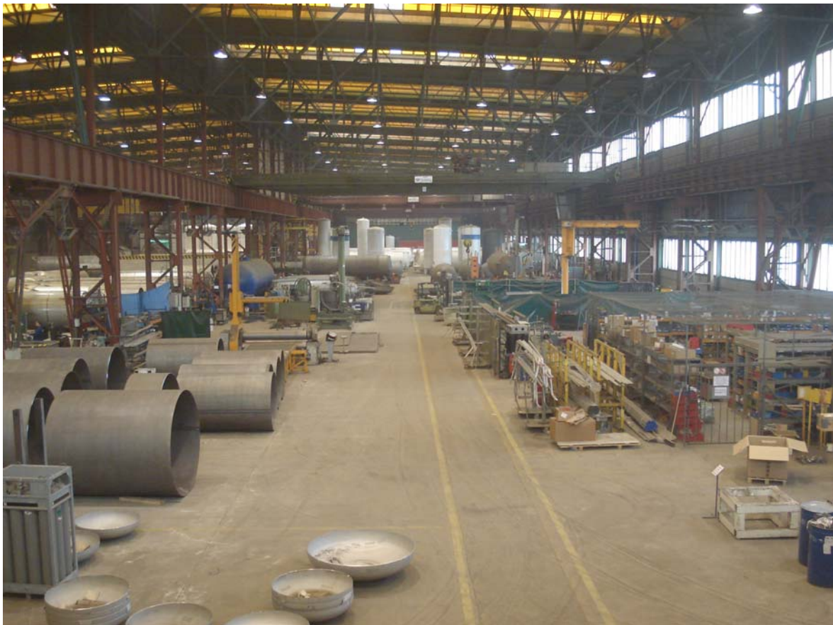
Vertikale, vakuum-isolierte Lagertanks in der Fabrikation
