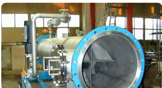
CO 2 -Zufuhr in den Hauptwasserstrom über den Teilstrom
