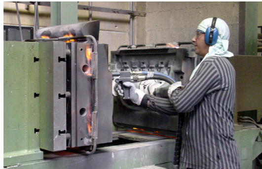
Reinigung einer eingebauten, heissen Kokille
