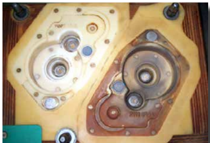
Entfernen von Trennmittel von einem PU-Kernkasten
