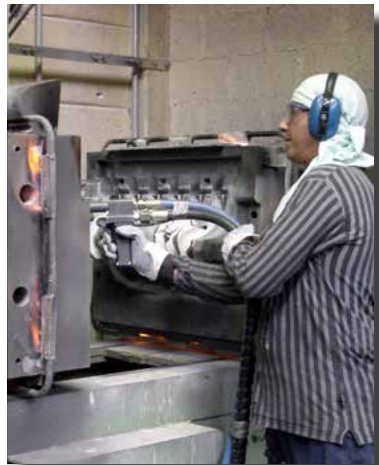
Reinigung von eingebauten, heißen Kokillen
