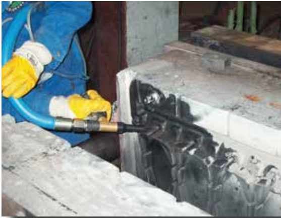
Reinigung einer heissen Kokille im eingebauten Zustand
