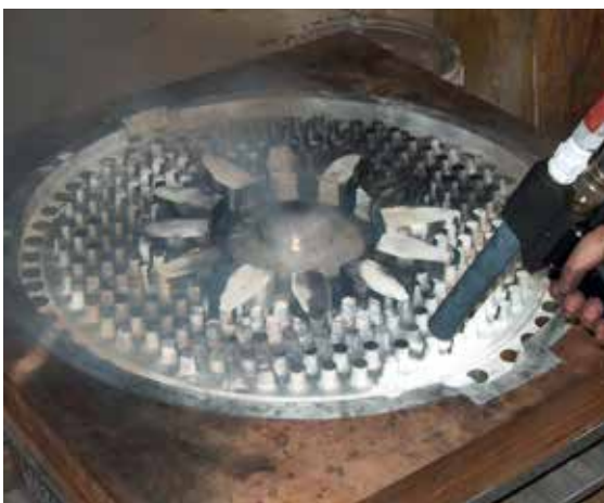
Reinigung eines Kernkastens in der Automobilindustrie
