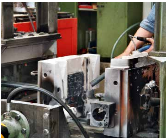
Mit der ASCO Trockeneisstrahltechnologie werden Produktionsstillstände vermieden.
