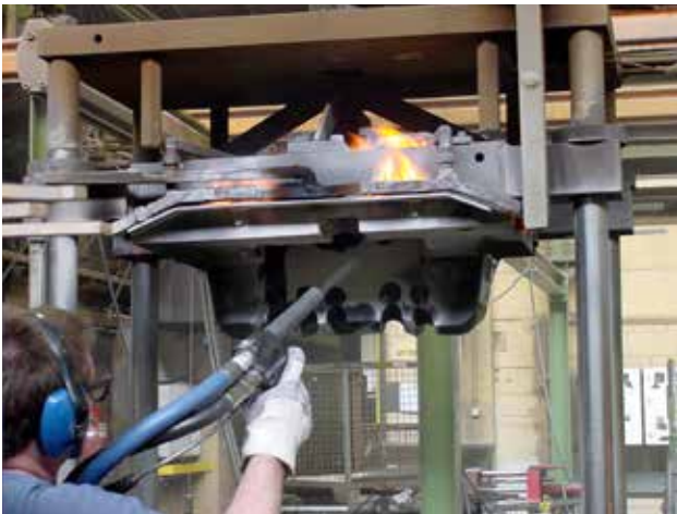
Kokillenreinigung in heissem Zustand
