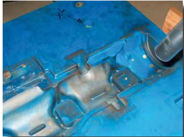
Kernkasten-Reinigung in einer Graugießerei
