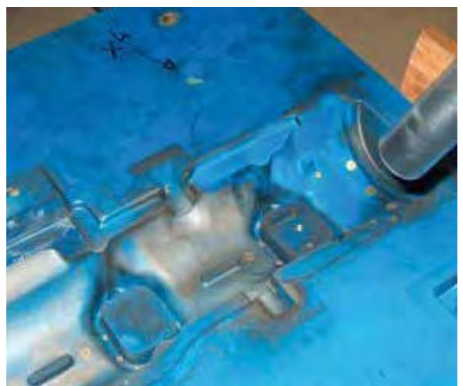
Bild 2: Kernkasten Reinigung in einer Graugießerei
