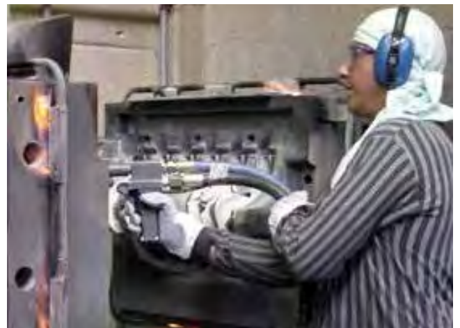
Bild 6: Reinigung von eingebauten, heissen Kokillen
