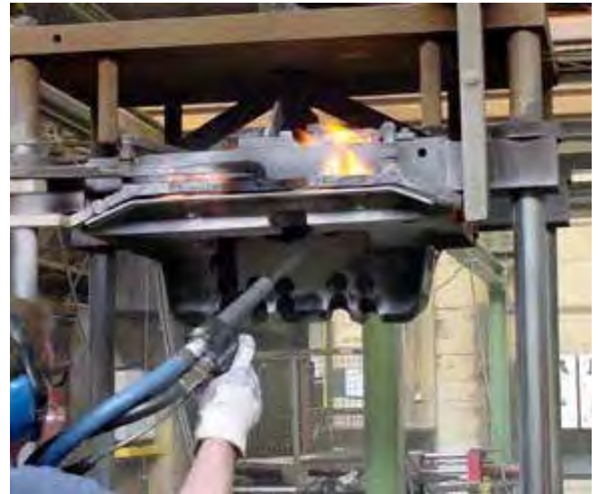
Bild 7: Entfernen von Trennmittel von einem Kunststoff Kernkasten
