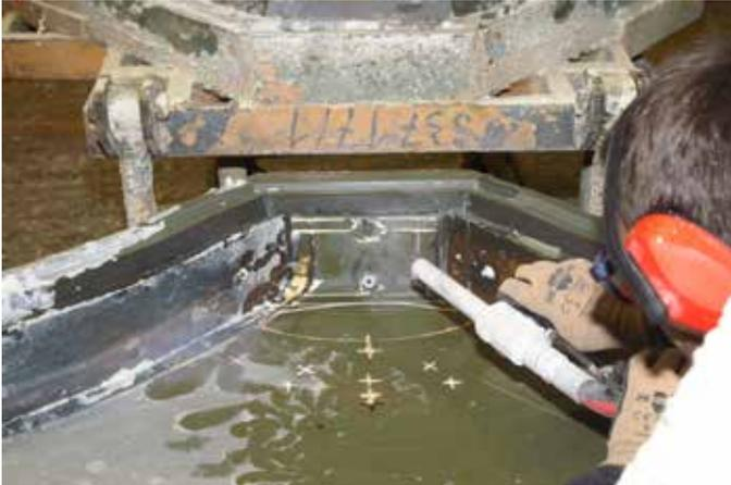
Bei der Reinigung der PU-Schäumwerkzeuge wird seit Einführung der Trockeneisstrahltechnik viel Zeit gespart.
