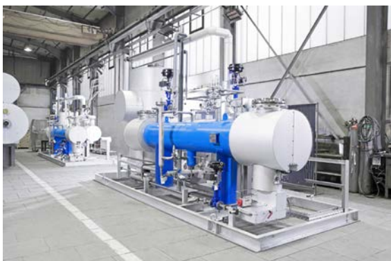
Bild 1 – ASCO Rückgewinnungsanlage für CO 2 als Nebenprodukt
