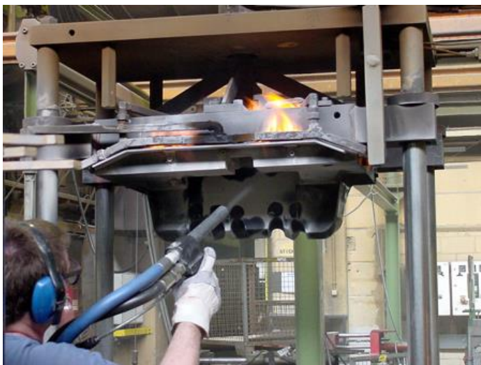
Bild 2 – Effiziente Reinigung einer heißen Kokille direkt auf der Produktionsmaschine.
