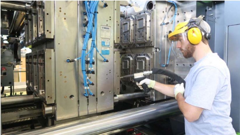
Bild 1 – Reinigen der Formen mit der ASCO Trockeneisstrahltechnologie
